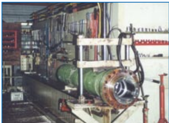
Demontagestand met opvang van olie
