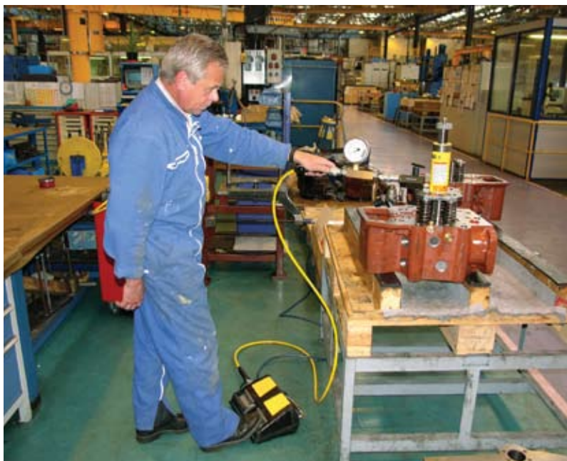
Avec les nouvelles pompes de la série XA d'Enerpac, dotées de la XVARI® Technology, l'opérateur dispose d'une force de frappe précise et maîtrisée pour comprimer et positionner les ressorts de valve d'un moteur diesel, avec un vérin à piston creux de 13 tonnes.
